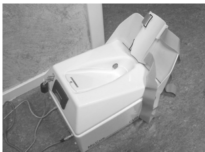
Figura 3. – Densitómetro por ultrasonidos que mide la cantidad de energía mecánica transmitida por el hueso entre fuente emisora y receptora.
